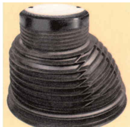
11. Alternativ: Dichtelement DN 625 in oberstes Rippental am Konus einlegen. Die Abdeckung B 125 direkt auf den Konus auflegen. Betonauflagering nicht erforderlich.
